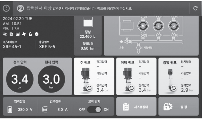
- 정상적으로 시스템이 작동 할 수 없는 이상 경고 발생 ⑥ 압력센서 이상 : MAIN 화면 상단에 점멸
