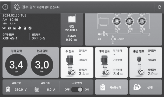
- 정상적으로 시스템이 작동 할 수 없는 이상 경고 발생 ⑤ 갈수 경고 : MAIN 화면 상단에 점멸
