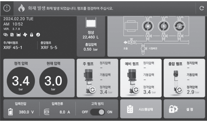
- 정상적으로 시스템이 작동 할 수 없는 이상 경고 발생 ⑦ 화재 발생 : MAIN 화면 상단에 점멸
